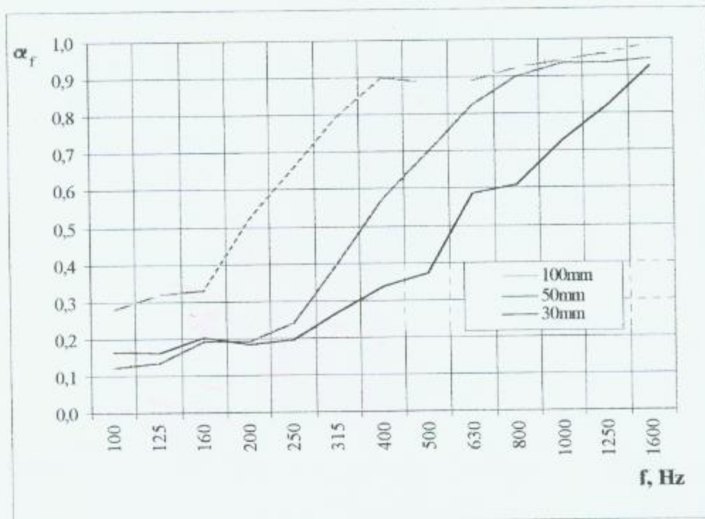
Rys. 1 Porównanie fizycznego współczynnika pochłaniania dźwięku płyt URSA TP2/V o różnych grubościach
