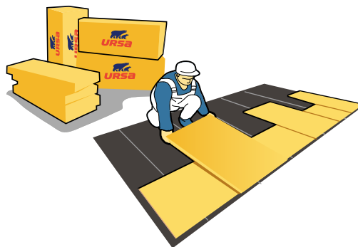
2 Układanie warstwy termoizolacji z płyt URSA XPS
